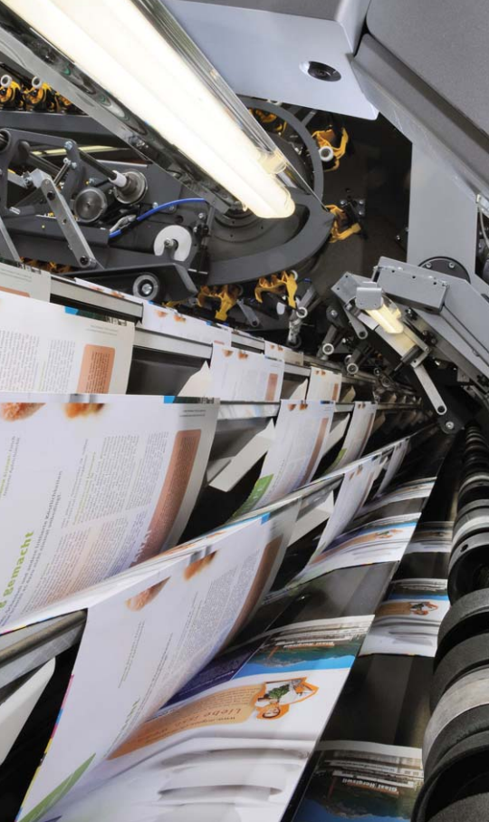
Bildverarbeitende Systeme haben im industriellen Bereich einen festen Platz erobert, wie zum Beispiel für die Erkennung von falsch eingelegten Bögen in der Printproduktion.
